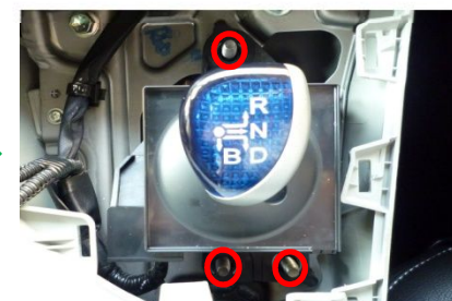
4/○印のナット 3本を外します
